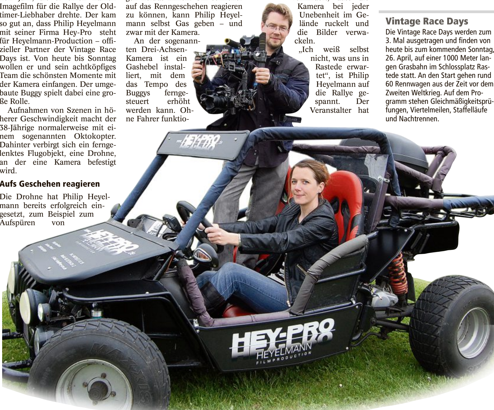
Teamarbeitet: Während Tanja Heyelmann den umgebauten Buggy lenkt und bremst, kann ihr Mann Philip sich auf die Aufnahmen konzentrieren. Am Kameragestell ist ein Gashebel installiert, über den Philip Heyelmann den Buggy per Fernsteuerung beschleunigen kann. Das Aufnahmegerät selbst verfügt über eine Aufhängung, die verhindert, dass die Kamera bei jeder Unebenheit ruckelt. Foto Oetting
